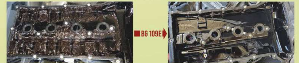
Удаление высокотемпературных отложений и лакообразований
