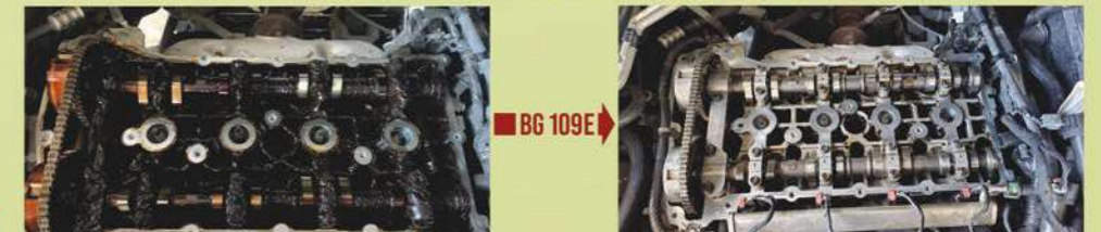
Удаление высокотемпературных отложений и лакообразований
