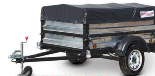
ПРИЦЕП «КРЕПЫШ» Масса/грузоподъемность: 750/565 кг Габаритные размеры: 3065x1710x1350
