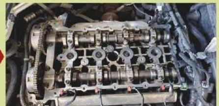
Удаление высокотемпературных отложений и лакообразований
