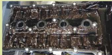
Удаление высокотемпературных отложений и лакообразований
