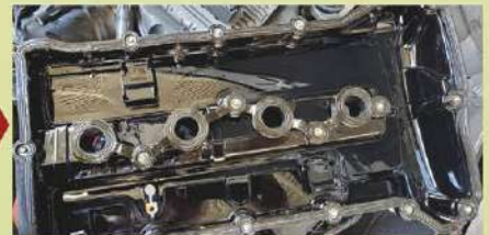
Удаление высокотемпературных отложений и лакообразований
