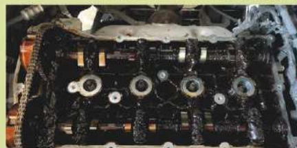
Удаление высокотемпературных отложений и лакообразований
