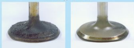
Камера сгорания ДО и ПОСЛЕ
