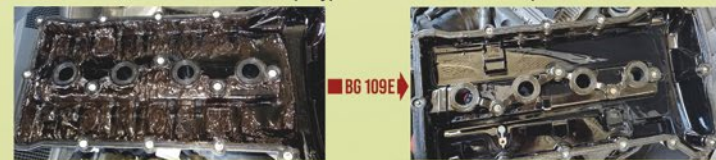
Удаление высокотемпературных отложений и лакообразований
