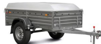
ПРИЦЕП ДЛЯ ДАЧИ С КРЫШКОЙ Масса/грузоподъемность: 750/550 кг Габаритные размеры: 1853x1231x470
