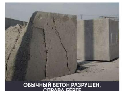
ОБЫЧНЫЙ БЕТОН РАЗРУШЕН, СПРАВА БЕРГЕ
