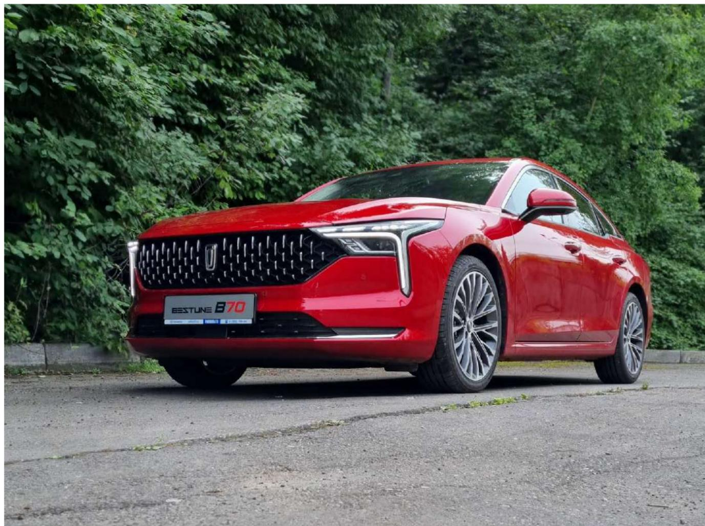
По размерам FAW Bestune B70 лишь немного меньше своих собратьев по модельному ряду – Toyota Camry, Kia K5: длина – 4810 мм, ширина – 1840 мм, высота – 1455 мм. Расстояние между осями – 2800 мм против 2825 мм у Тойоты и 2850 мм у Kia. Также автомобиль отличается вместительностью багажника, объем составляет 522 литра.
