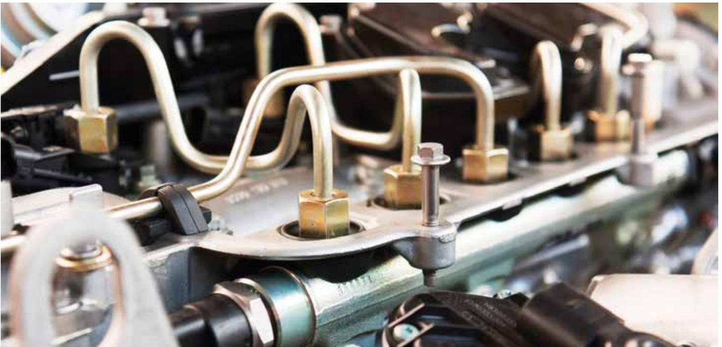
Нарушения в работе двигателя, как правило, свидетельствуют о засорении топливной системы. Это приводит к затруднению пуска, снижению мощности и приемистости двигателя.
