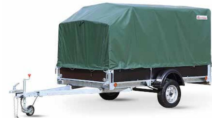
Например, все швы прошиваются специальными прочными нитками. Тент надевается на каркас из металлических дуг и фиксируется прочным шнуром к бонкам на бортах, что позволяет надежно зафиксировать тент на прицепе. Для удобства попадания в прицеп, в тенте делают двери. На большинстве прицепов имеется передняя и задняя дверь, а на прицепах для перевозки снегоходов и квадроциклов в тенте прицепа имеется боковая дверь, чтобы можно было заправлять технику прямо на АЗС.
