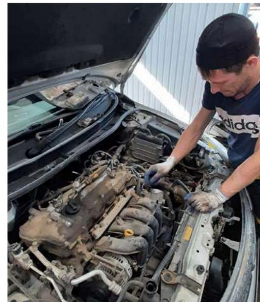
ет наличие и состояние хомутов, датчиков, проводов, фильтра, свечей зажигания, замеряет компрессию в цилиндрах.
