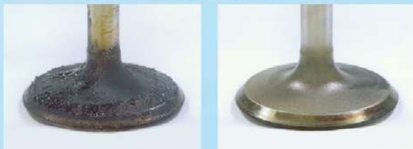
Камера сгорания ДО и ПОСЛЕ
