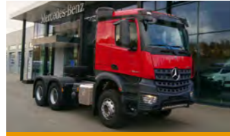
MERCEDES-BENZ AROCS 3348 S , дизель, 6x4, 12.8 л, 476 л.с, г/п 120 т, КПП робот.
