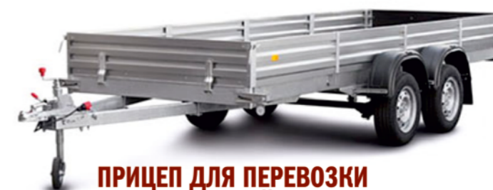
ПРИЦЕП «КРЕПЫШ» Масса/грузоподъемность: 750/565 кг Габаритные размеры: 3065x1710x1350
