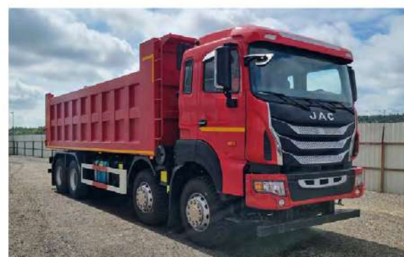
N410 8х4, г/п 41 т, 11.6 л, дизель с турбонаддувом Weichai, Евро-5. Кузов объемом 26 куб. м.
