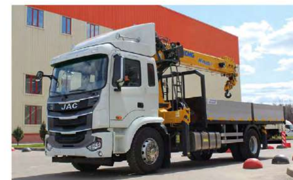
N200 6,7 л, турбодизель ISD285 50 стандарта Евро-5, 8МКПП. Подвеска рессорная.
