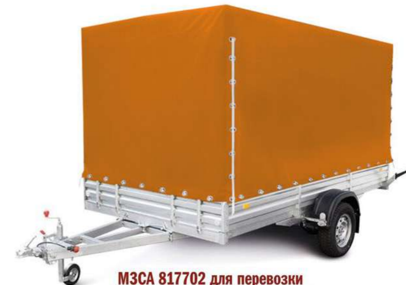
ПРИЦЕП «УНИВЕРСАЛ» Масса/грузоподъемность: 750/535 кг Габаритные размеры: 3555x1850x980
