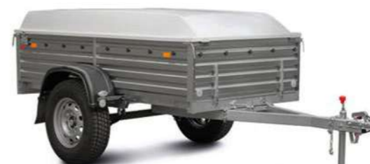
ПРИЦЕП ДЛЯ ДАЧИ С КРЫШКОЙ Масса/грузоподъемность: 750/550 кг Габаритные размеры: 1853x1231x470
