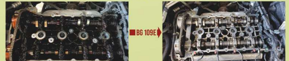
Удаление высокотемпературных отложений и лакообразований
