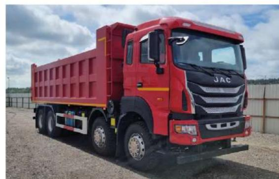
**N410** 8x4, г/п 41 т, 11.6 л, дизель с турбонаддувом Weichai, Евро-5. Кузов объемом 26 куб. м.
