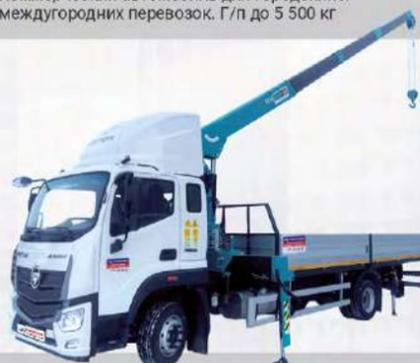
КМУ. Двигатель Cummins, КПП ZF, двигатель 4,5 - 210 л.с. Г/п до 8 000 кг. Лидер в своем классе
