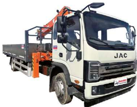
N120 Универсальность, надежность и долговечность. Комфорт и безопасность. Макс г/п КМУ 5000 кг.
