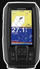
STRIKER PLUS 4 Эхолот с дисплеем 4,3", GPS, передовым сонаром и программой Quickdraw Contours для создания карт
