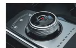
Электронный селектор КПП
