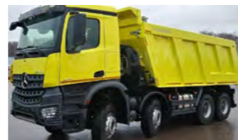
MERCEDES-BENZ AROCS 4145 K, дизель, 8x4, 12.8 л, 476 л.с., г/п 33 т, КПП робот.
